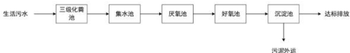
图7-1 生活污水处理工艺流程图
