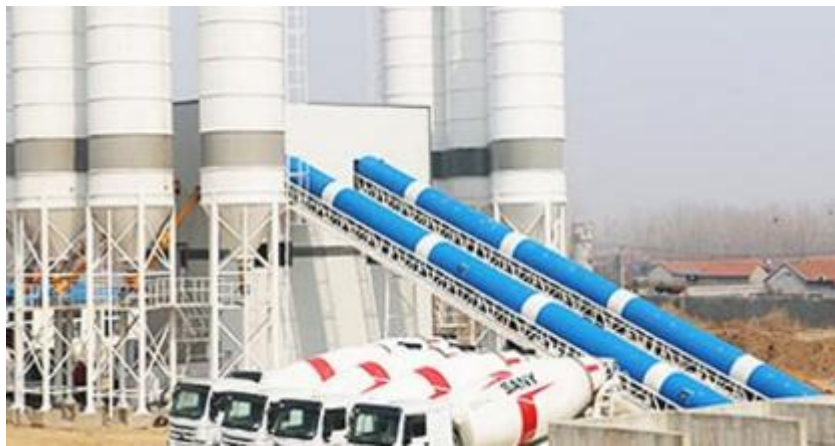
图 5-4 密闭的螺旋输送机管道示意图
