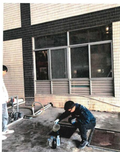
生产废水治理设施前采样口 2#
