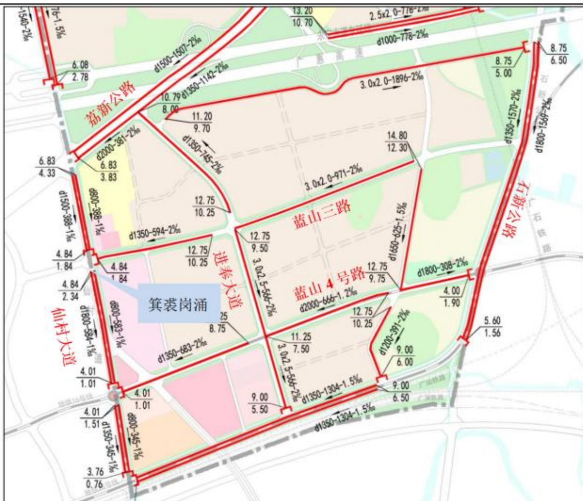
图 3.12-2 雨水工程规划图
