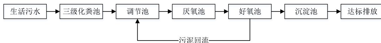
图 4-2 项目生活污水处理工艺流程图
